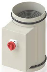
При отрицательной наружной температуре следует устанавливать электрический преднагрев во избежание образования наледи внутри установки. Данный преднагреватель подключается к воздуховоду наружного воздуха.
