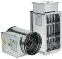
Электрические нагреватели доступны в качестве опции для установки в зонах с прохладным климатом (монтируются в канале приточного воздуха) и с холодным климатом (в этом случае нагреватели устанавливаются в канале приточного и наружного воздуха, что обеспечивает защиту от обмерзания). Электрические нагреватели совместимы с воздуховодами прямоугольного и круглого сечения.
