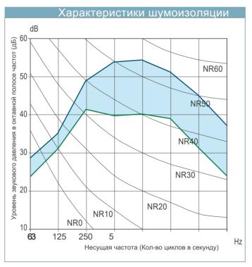
\*Акустические испытания проводились на расстоянии 1,5 метров от установки.
